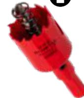
Unsere 28mm Lochsäge aus Bimetall überzeugt mit einer enormen Standfestigkeit dank der Kombination von HSS-Stahl und Cobalt-legiertem M42-Stahl. Die progressive Wechselverzahnung garantiert präzise, saubere Bohrungen in Aluminium, Holz, HPL, Kunststoff und Leichtmetall.
